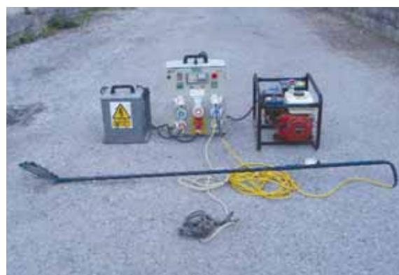
Equipamento completo de tipo electrogerador a gasolina, incluindo gerador, conversor, amplificador de corrente, ânodo e cátodo.
