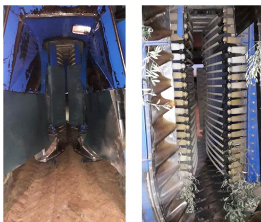
Figura 11. Abertura frontal da máquina por onde passam as árvores em sebe e conjunto de varas que batem nas oliveiras para libertação das azeitonas e que provocam a morte das aves (vista posterior).
