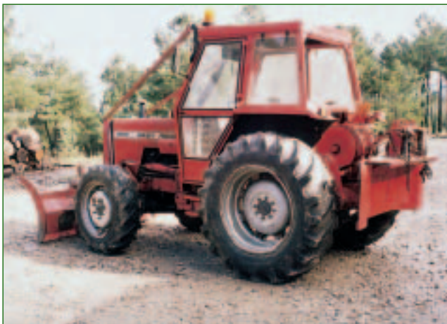
Figura 31 – Trator agrícola adaptado ao trabalho florestal com guincho e lâmina frontal
